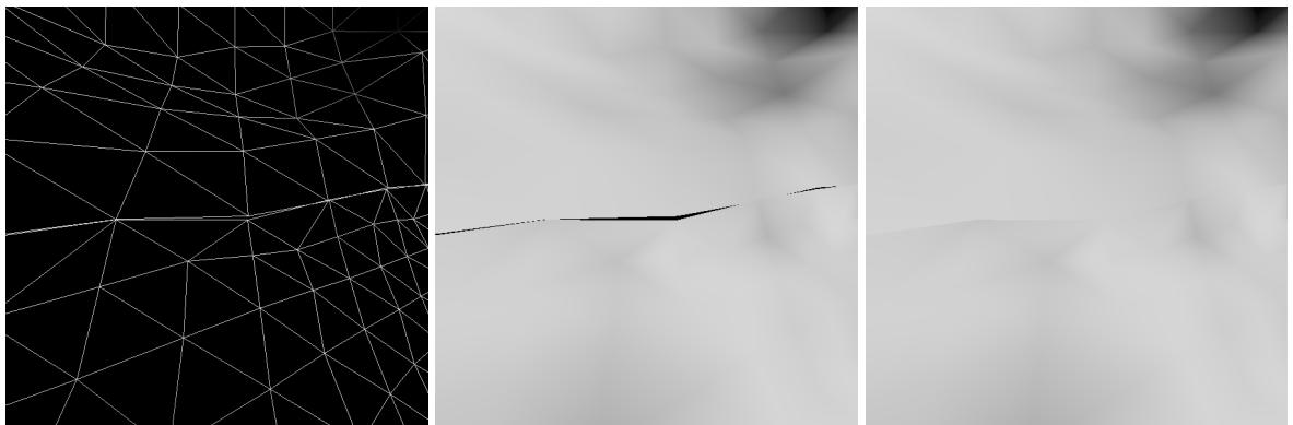
Kuvio 25. Kahden naapurisolmun raja. Ensimmäisessä kuvassa nähdään, kuinka tiheämpi kolmioverkko yhdistyy väljempään, toisessa havaitaan rako solmujen välillä ja kolmannessa helmalla peitetyn raon paikkeilla erottuu sauma.
