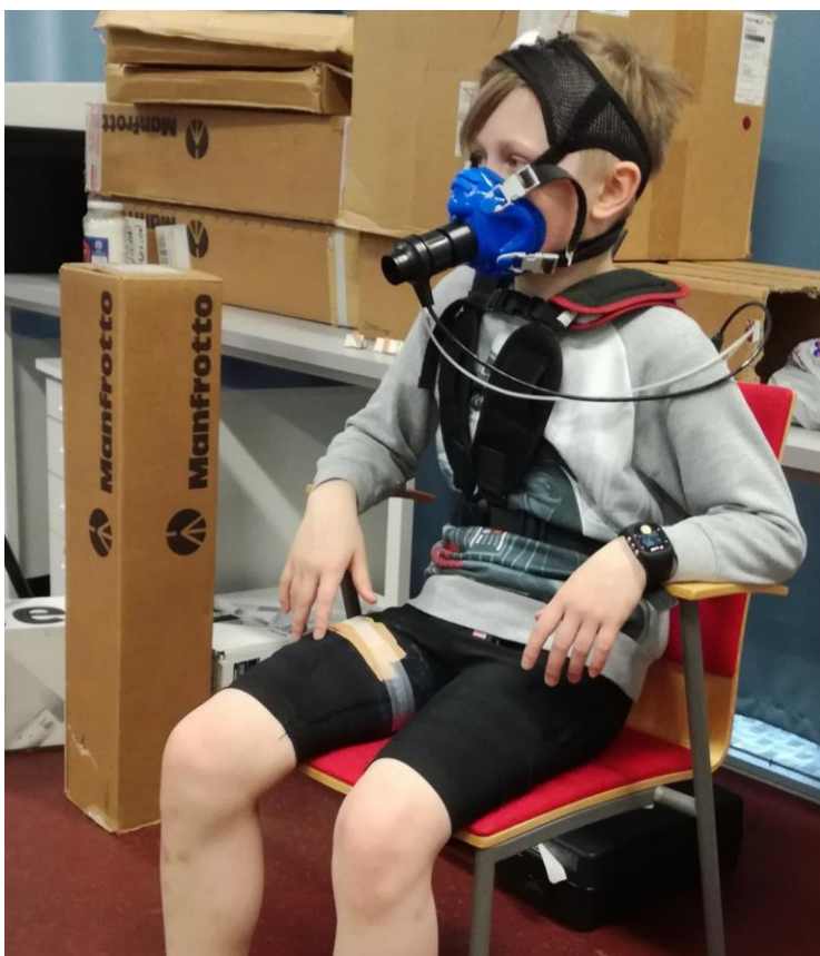
KUVA 9. Kannettava hengityskaasuanalysointilaitteisto tutkittavan päällä mittausvalmiudessa.
