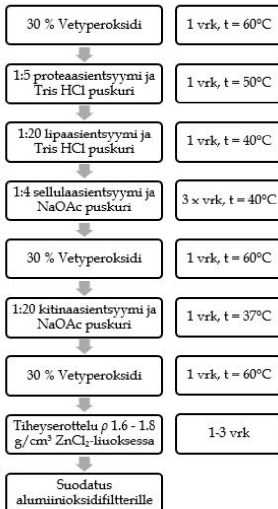
Kuva 3. Kaaviokuva tässä työssä käytetystä eristysmenettelystä. Vasemmassa sarakkeessa on käytetty liuos ja oikealla puolella vastaavasti käsittelyn vaatima aika vuorokausina ja lämpötila (t) Celsiusasteina. (Löder ym. 2017).
