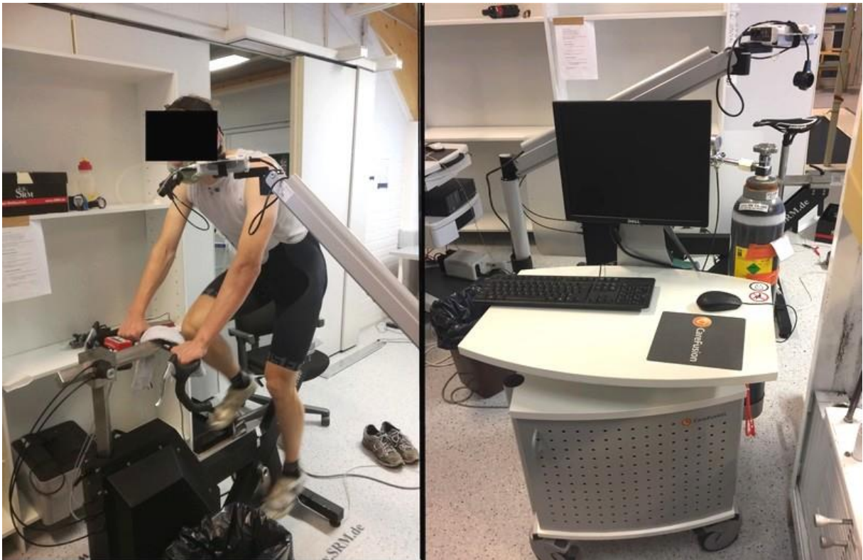
KUVA 4. MasterScreen CPX-hengityskaasuanalysointilaitteeseen ja sen käyttö pyöräilyn aikana.
