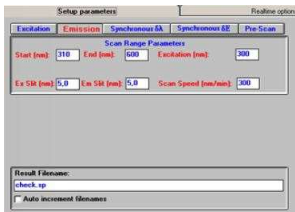
Kuva 4. Laitteen tarkistuksen asetukset ultrapuhdasta vettä sisältävillä näytteillä ennen varsinaista tutkimusliuosten mittausta.
