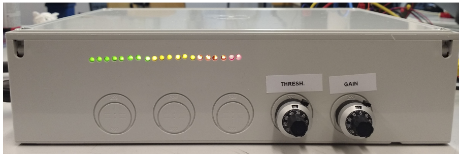
Kuva 17. Ohjausyksikön toinen sivu, sisältäen LED-pylvään ja kynnysvahvistimen säätöön käytetyt potentiometrit.
