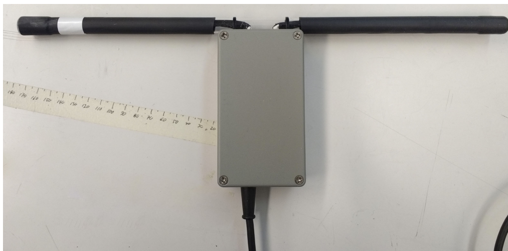
Kuva 15. Anturiosa, joka koostuu anturi- ja referenssisolenoidit sisältävästä akryyliputkesta (anturilla valkoinen merkki) sekä elektroniikan sisältävästä alumiinisesta kotelosta.
