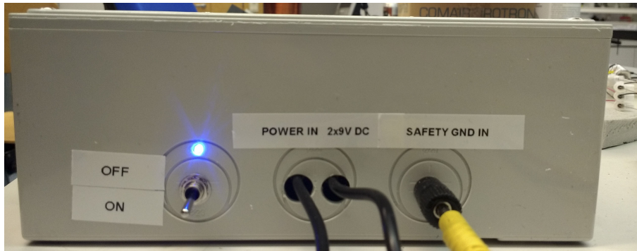
Kuva 16. Ohjausyksikön ensimmäinen sivu, sisältäen käyttöjännitteen ja maadoituksen sisääntulot sekä virtakytkimen.
