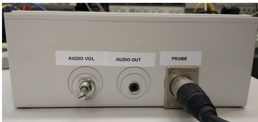
Kuva 18. Ohjausyksikön kolmas sivu, sisältäen äänisignaalin ulostulon, äänen-voimakkuuden säätöön käytetyn potentiometrin ja anturiosan johdon liitoksen.
