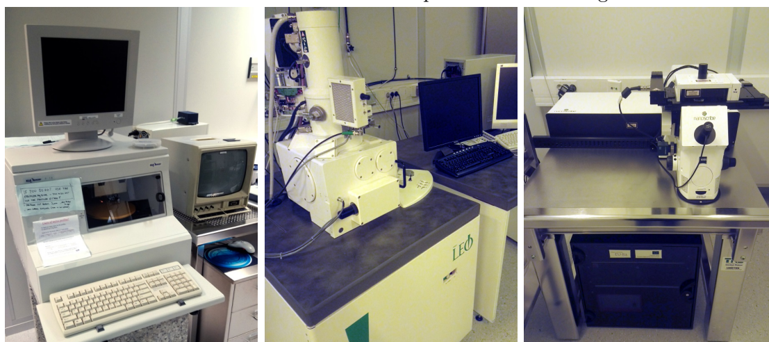
(d) KLA Tencor P-15 pro-filometer. (e) LEO 1430 Scanning electron microscope. (f) Nanoscribe Photonic Professional.
