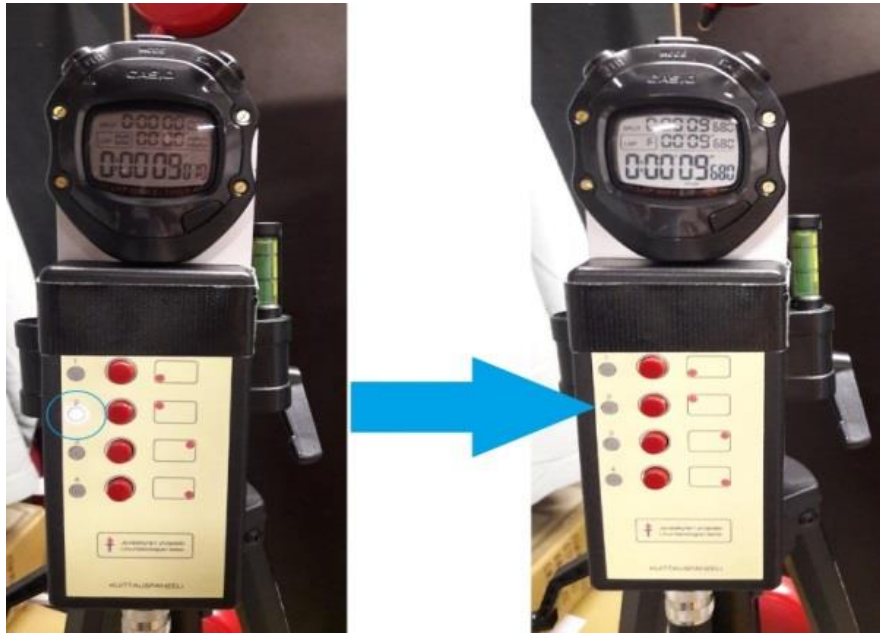
KUVA 6. Reaktioaikataulun kauko-ohjaimen painikkeen vasemmalla puolella oleva valo syttyi, kun painiketta painettiin ja sammui, kun tutkittava painoi reaktioaikataulun vastaavaa painiketta.
