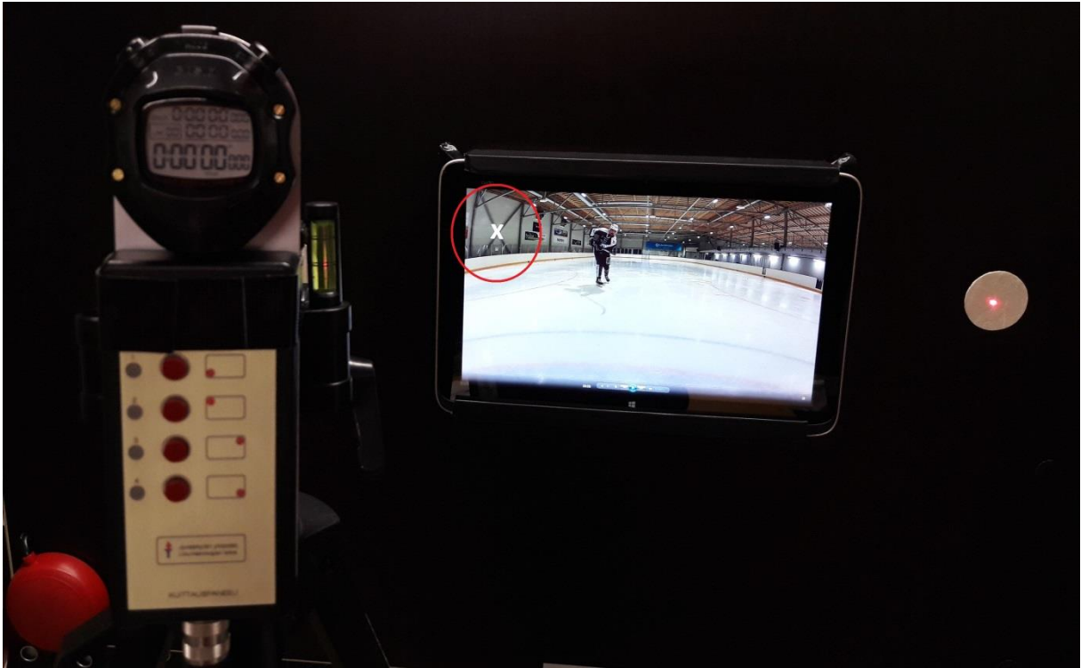
KUVA 5. Kauko-ohjain ja sekuntikello sekä kiskoilla oleva näyttö, jonka vasemmassa yläkulmassa valkoinen X-kirjain, joka esiintyy sillä hetkellä, kun kiekko irtoaa lavasta ja näkyy näytöllä yhden sekunnin ajan. Tämänkaltaista kuvaa videokuvattiin taulun vasemmalta puolelta suurnopeuskameralla.
