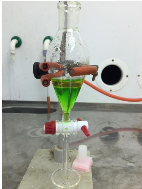
Kuva 4. Neste-neste-utto, jossa fosfori on sidottu vihreään kuningasvesifaasiin.
