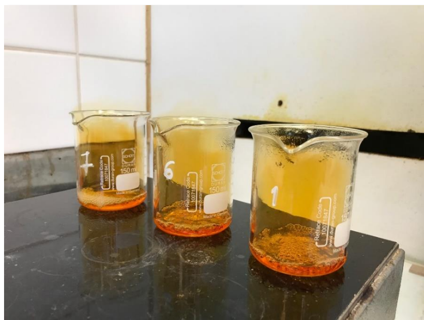
Kuva 36. Klassinen avoin hajotus keittolevyllä typpihapon ja vetykloridin 1:1 seoksella.
