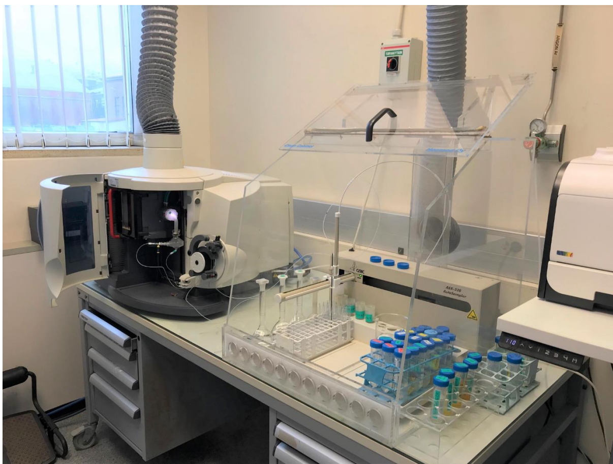
Kuva 32. Tässä työssä käytetty Thermo ICAP 6500 DUO ICP-OES -spektrometri oheislaitteineen.
