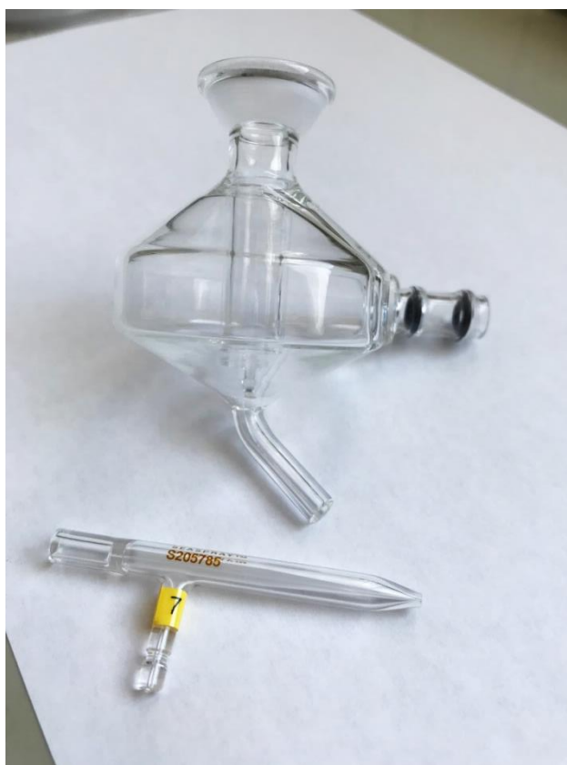
Kuva 22. Ylhäällä sykloninen, nousuputkellinen sumutinkammio ja alhaalla Meinhard-lasisumutin.
