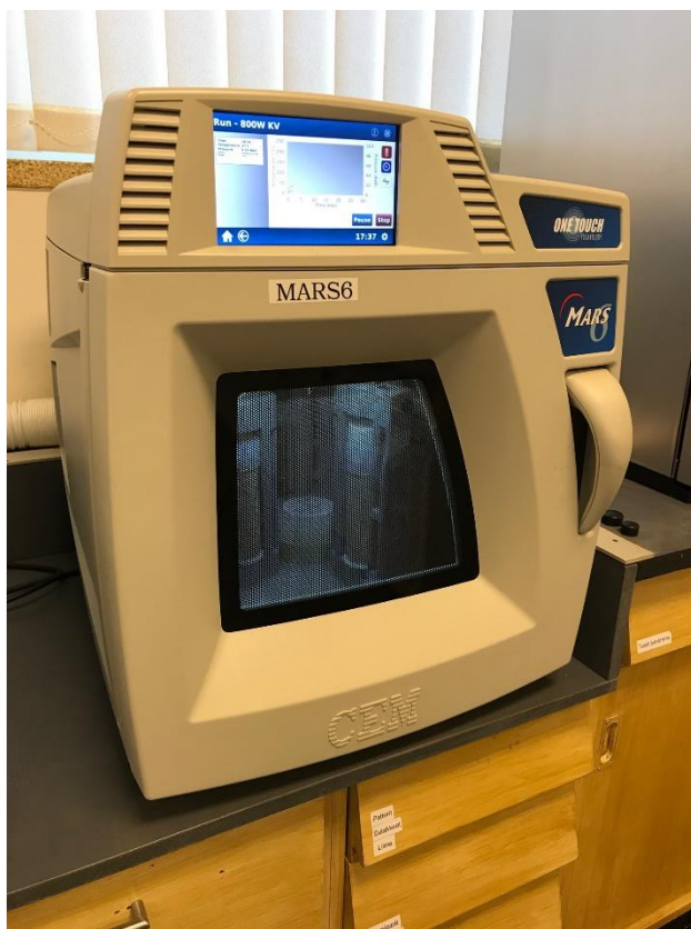
Kuva 37. Työssä käytetty CEM MARS 6 -mikroaaltouuni.
