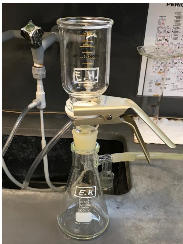
Kuva 35. Työssä käytetty imusuodatuslaitteisto.
