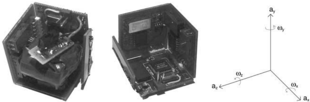
Kuvio 1. Esimerkki inertiamittausyksiköstä.(Benbasat ja Paradiso 2001, 11)
