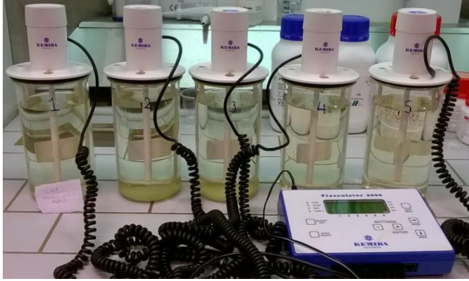
Kuva 10. Fosforin saostus jätevedestä alumiinisulfaatilla eri alumiinipitoisuuksissa.
