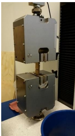
Kuva 41. Koekappale aineenkoestuskoneen leukojen välissä.
