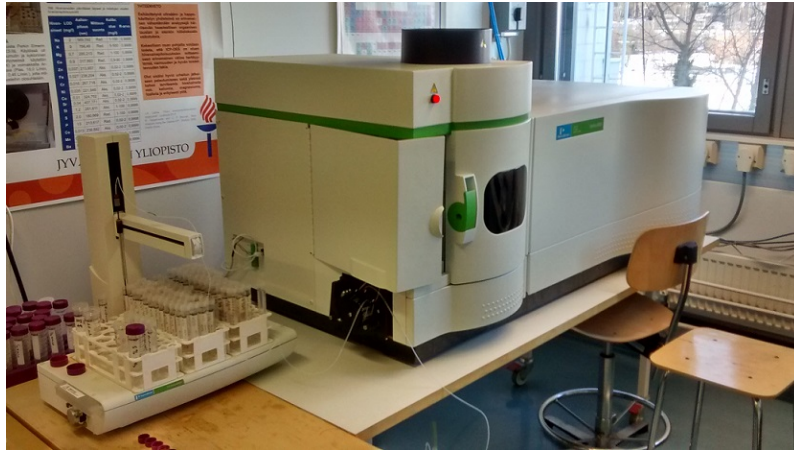
Kuva 7: Perkin Elmer Optima 8300-sarjan spektrometri. Vasemmalla puolella on näytteiden mittaamista nopeuttava automaattinen näytteensyöttäjä.
