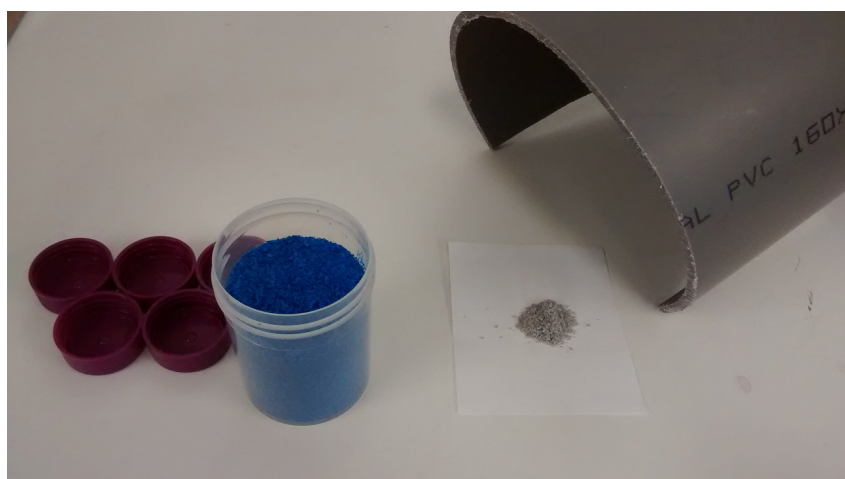
Kuva 13: Korkit ja jätevesiputki olivat jauhettu käsiteltävään muotoon.
