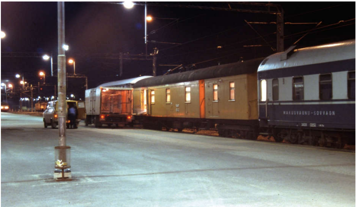
Kuva 10. Viimeinen Pasilan konepajan rakentama puukorinen vaunu oli (Po)-sarjan postivaunu numero 9843, jonka valmistuspäivä oli 18.12.1959. Kuva Jari Auvinen Pieksämäki 25.10.1984.
