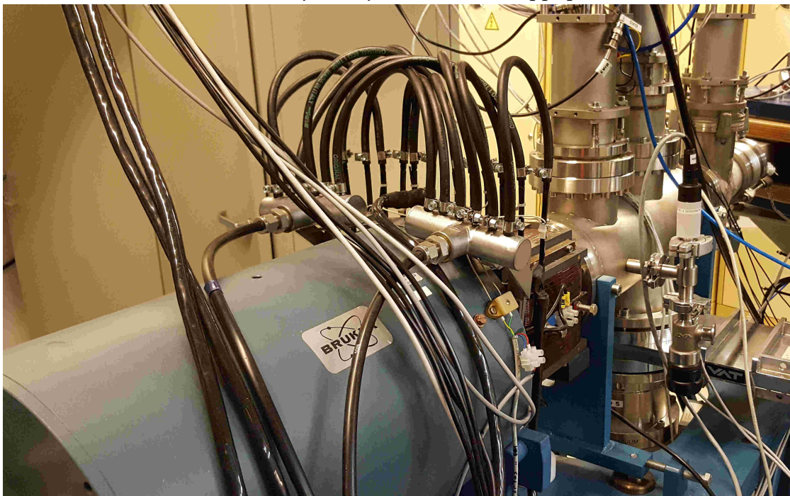
(b) Suihkulinjan suojattavan alueen alkupää. Kuvan oikealla puolella oleva metallin värinen osa suihkulinjasta on erityisen haastava suojattava sen monimutkaisen geometrian vuoksi.
