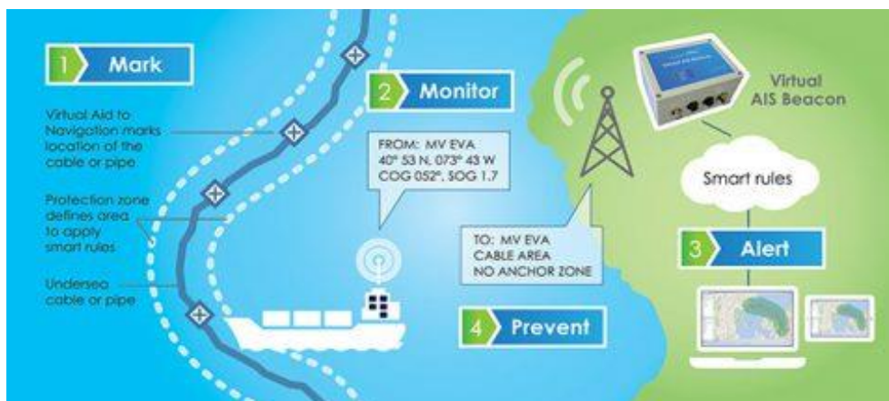
KUVIO 12. AtoN-järjestelmän toiminta periaate. Kertoo, miten virtuaalinen-ATON toimii käytännössä. (Subsea Worlnews, 2016)
