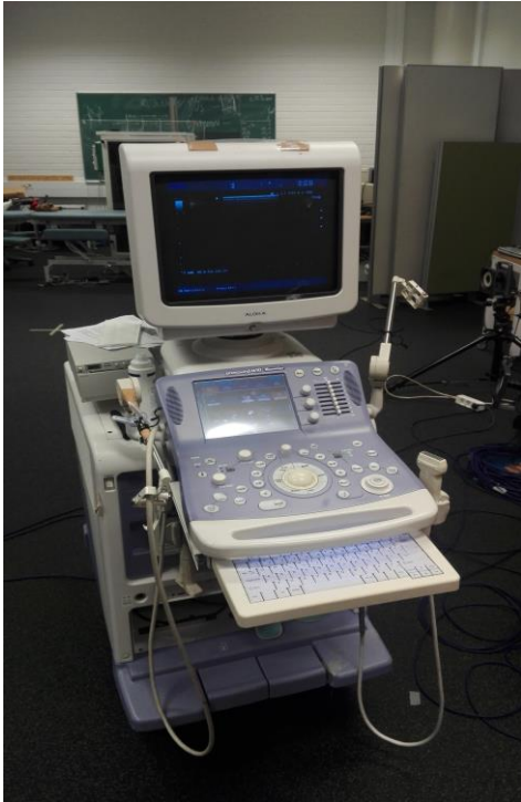
KUVA 1. Aloka Alpha 10 ultraäänilaitte. Oikealla näkyy tutkimuksessa käytetty äänipää.
