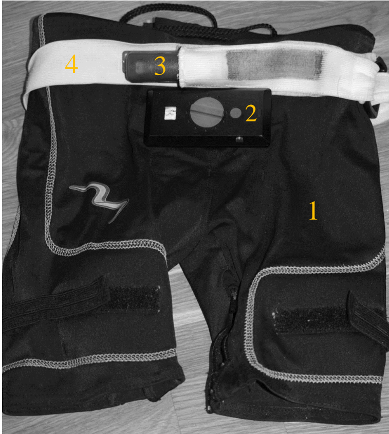
KUVA 4. Tutkimuksessa käytössä ollut mittaus välineistö: nro. 1-EMG shortsit, 2-EMG housujen moduli, 3-kiihytyvyysanturi, 4-kiihytyvyysanturin vyö.
