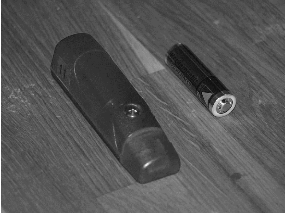
KUVA 5. Tutkimuksessa käytetty kiihtyvyyssanturi ja virtalähde.
