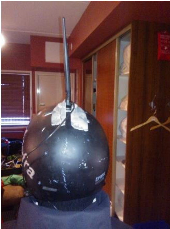
KUVA 18. WLAN-antenni teipattuna tutkittavan kypärään.
