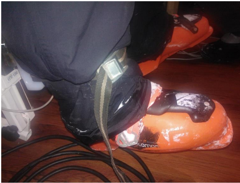
KUVA 21. Tutkittavan nilkka sidottuna kuormansitomisliinalla voimapenkkiin.
