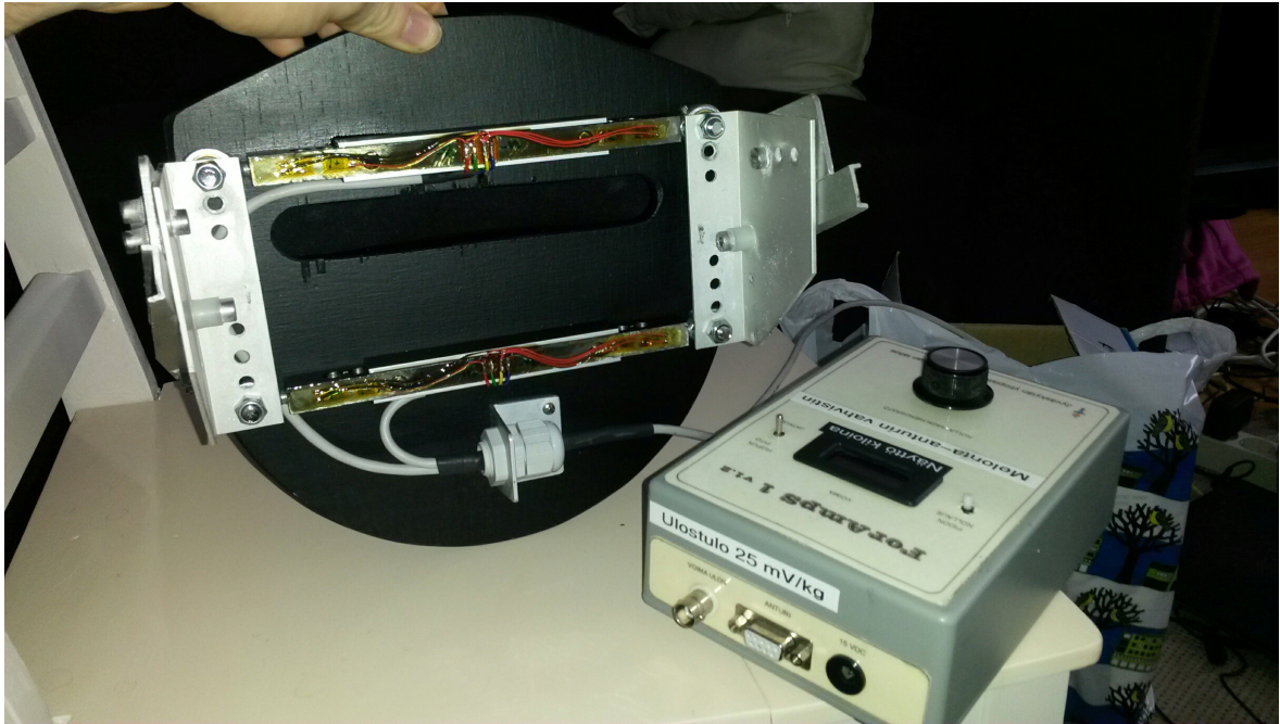
KUVA 11: Jalkavoima-anturi takaa ja voimanvahvistin.
