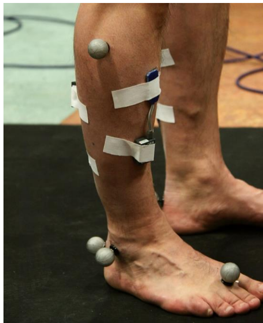
KUVA 9. Pintaelektrodit ja niiden lähettimet, sekä liikeanalyysin markkeripallot.
