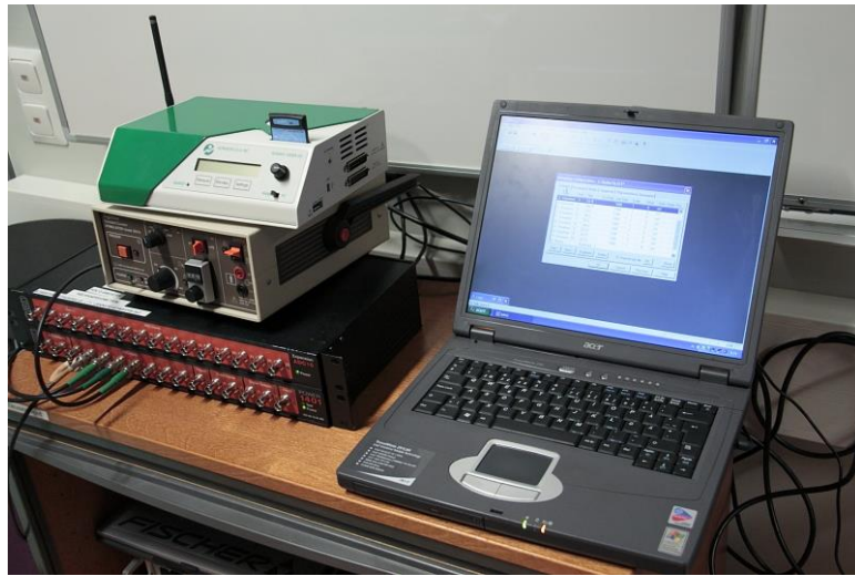
KUVA 10. Noraxon –mittalaite, CED A/D –muunnin, DS7A Digimeter ja datan tallennuskone
