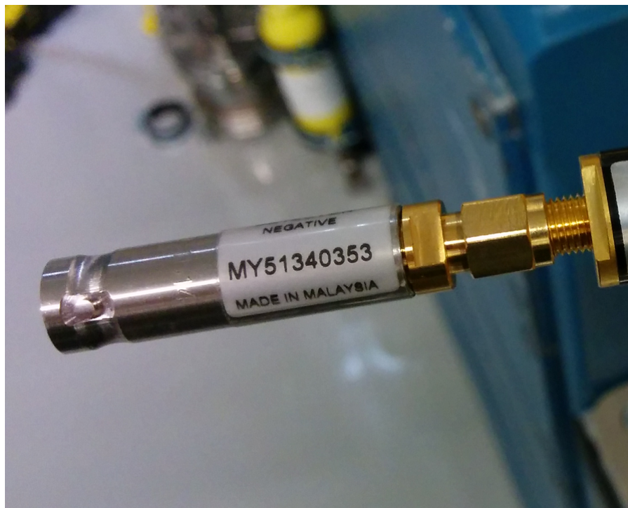
Kuva 35. Mittauksessa käytetty Keysight Technologies 8473C diodi. Diodin toinen pää on SMA -liitin (oikealla) ja toinen BNC -liitin.
