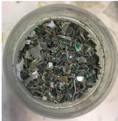
Kuva 2. Murskattuja matkapuhelinten piirilevyjä.
