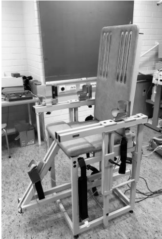
KUVA 8. Maksimaalista polven ojennus- ja koukistusvoimaa mittaava mittaustuoli (Good Strength, Metitur, Jyväskylä).
