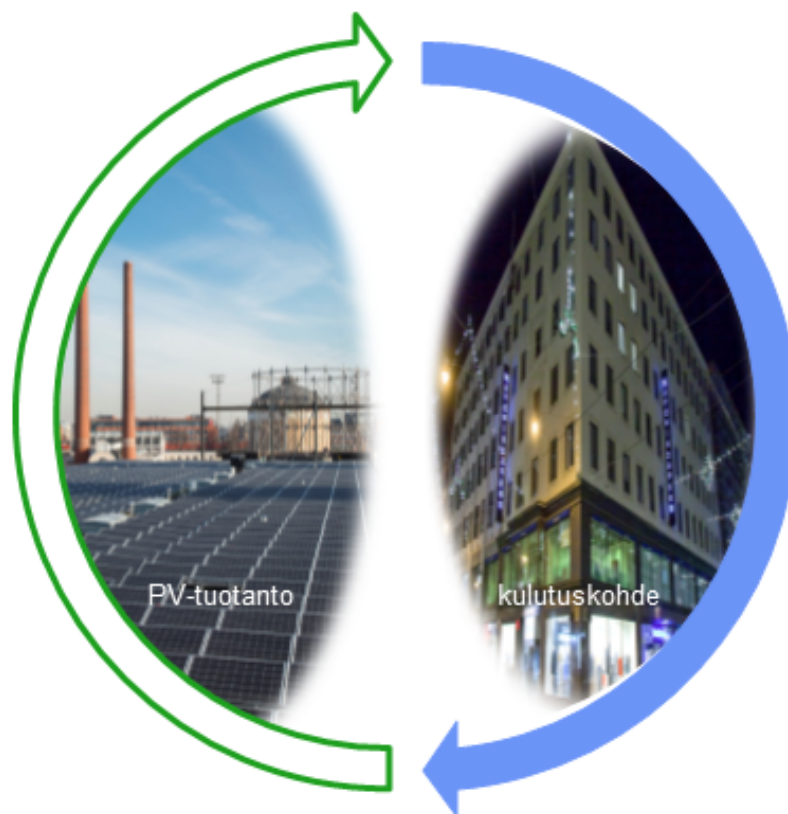
Kuvio 11. Aurinkovoimalaitos voidaan kytkeä suoraan kulutuskohteeseen, jolloin aurinkosähköä on mahdollista käyttää, kun kulutus vastaa tuotantoa.
