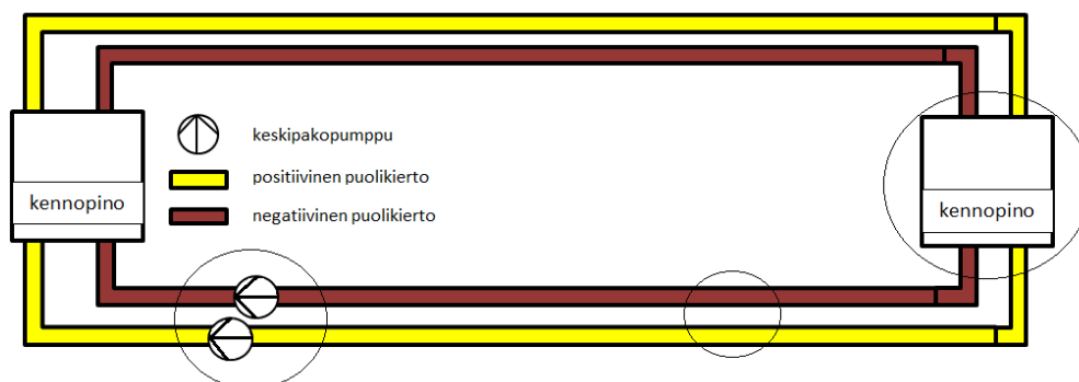
Kuvio 6. Yksinkertaistettu esitys hajautetusta virtausakusta, joka rakentuu kahdesta maantieteellisesti erillään olevasta kennopinosta ja niiden maanalaisesta putkiverkkoyhteydestä. Putkiverkostossa kiertää elektrolyytti, jota pumpataan pumpuilla. Virtausakun kennossa anodilla ja katodilla kiertävät omat toisistaan erotetut elektrolyytit, anolyytti ja katolyytti, joiden suljettua kiertoa kutsutaan negatiiviseksi ja positiiviseksi puolikierroksi vastaavasti.
