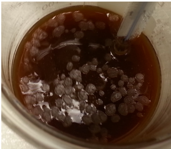
Kuva C.1. Keittoliuosnäytteessä I 97 °C:ssa havaittu saostuma.
