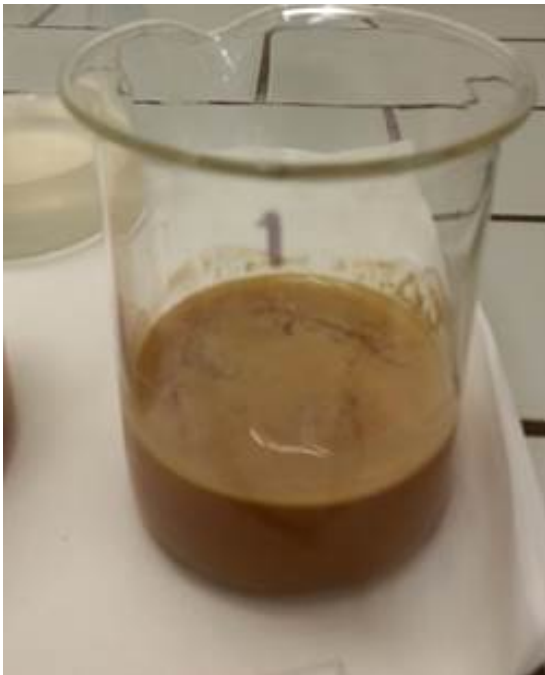
Kuva C.5. Keittoliuosnäytteen III saostuma sen jäähtyttyä.
