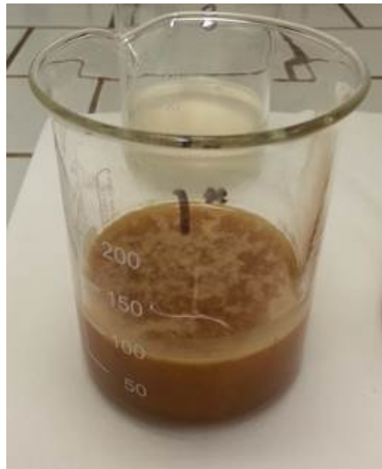
Kuva C.6. Keittoliuosnäytteestä IV jäähdytymisen aikana syntynyt saostuma.
