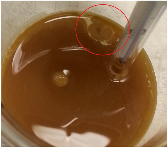
Kuva C.3. Keittoliuosnäytteessä III 70 °C:ssa havaittu saostuma.
