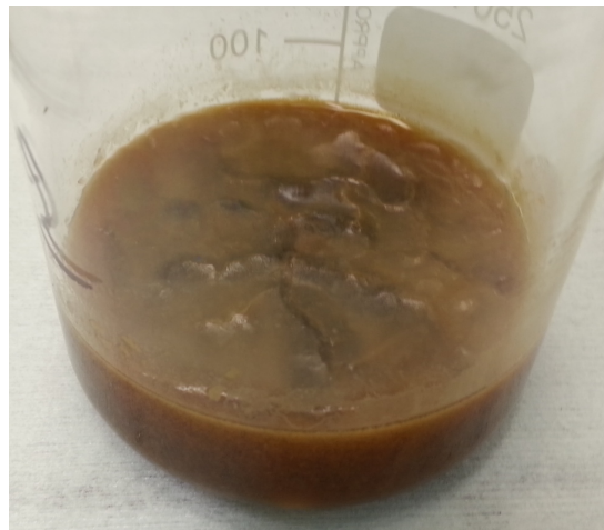
Kuva C.2. Keittoliuosnäytteestä I syntynyt saostuma jäähtymisen jälkeen.
