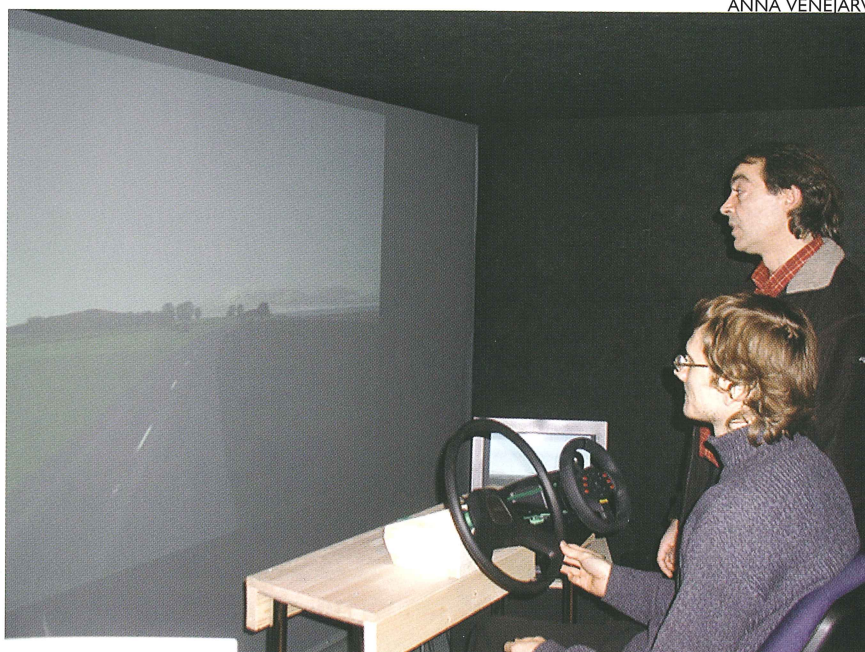
Agora Innoroad Laboratoryn vetäjä Olli Bräysy (istumassa) ja erikoistutkija Narciso González Vega kokeilevat ajosimulaattoria, jonka avulla tutkitaan ihmisen käyttäytymistä liikenteessä.
