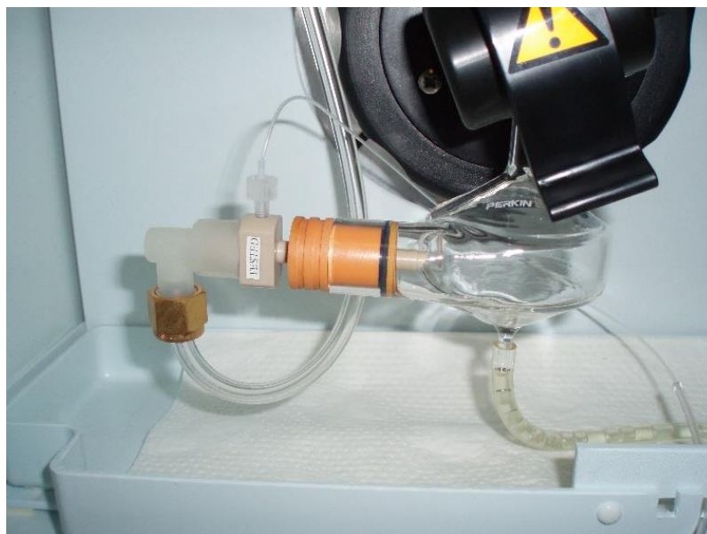
Kuva 11. Sykloninen sumutinkammio varustettuna GemCone low-flow -sumuttimella
