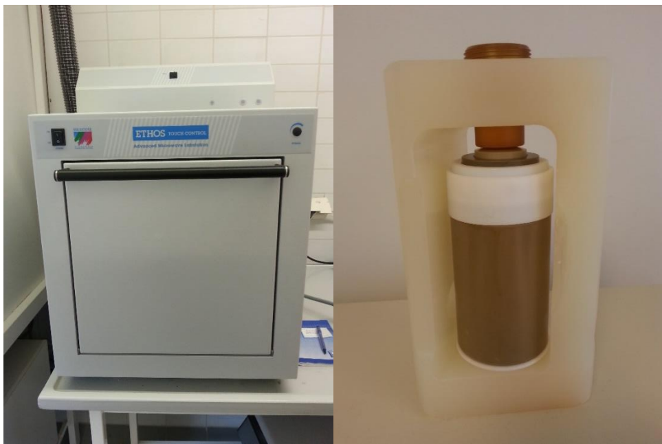
Kuva 16. a) Ethos Touch Terminal 320-mikroaaltouuni b) TFM Teflon mikroaaltoputki
