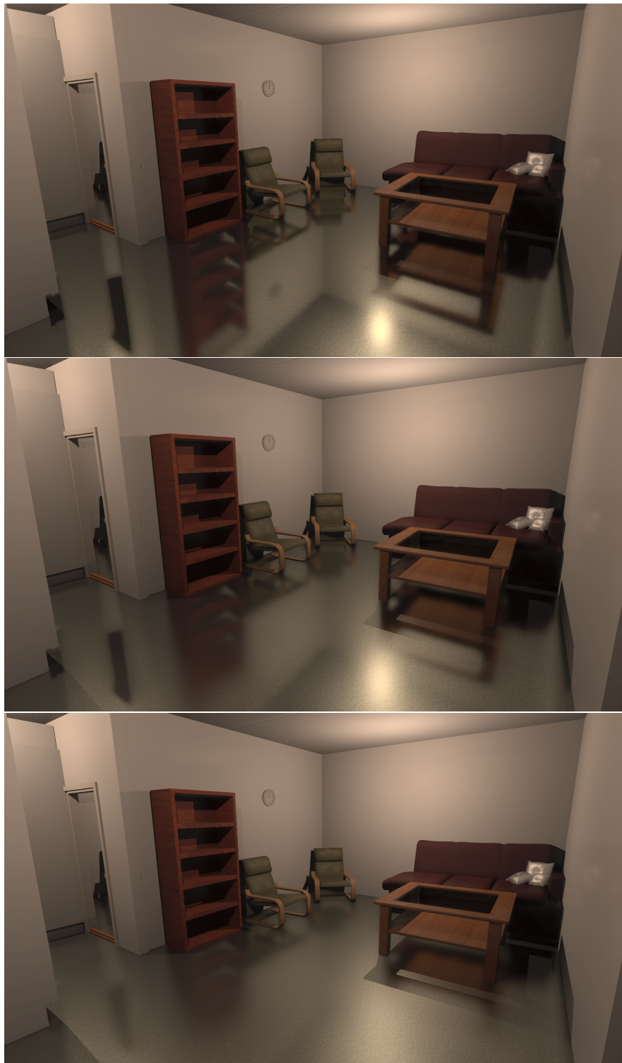
Kuvio 24. Kuviossa fysikaalisten kuvapuskuriheijastusten tulos. Lattian heijastuksissa on havaittavissa, kuinka materiaalin karheus vaikuttaa heijastusten sumeuteen. Lattian karheus arvot ovat \sigma = 0.08, 0.24, 0.4 .
