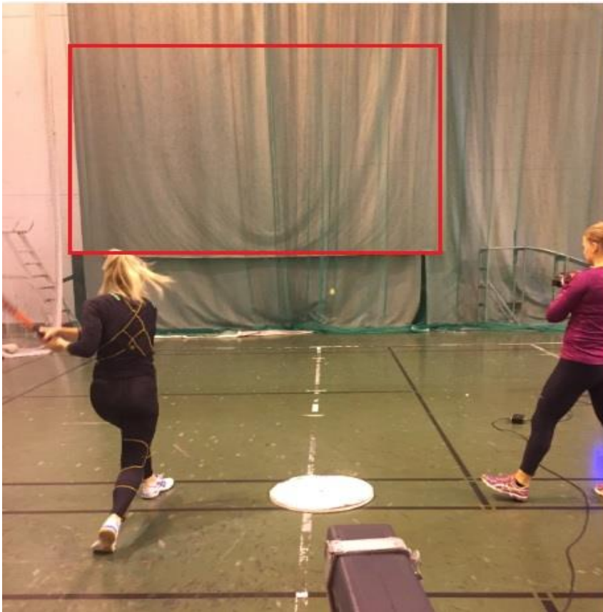
KUVA 8. Lyöntitestin osuma-alue korostettu punaisella neliöllä. Osuma-alueen leveys viisi metriä ja korkeus neljä metriä.
