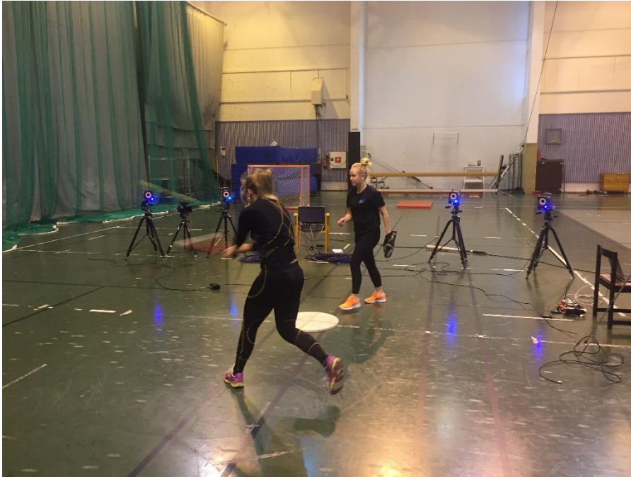
KUVA 9. Neljä Viconin T40S-kameraa lyöjän vastakkaisella puolella. Etäisyys lyöntipisteeseen neljä metriä.
