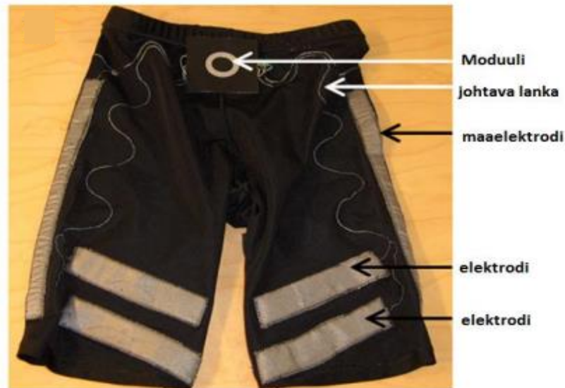
KUVA 5. EMG-shortsit sisäpuolelta kuvattuna. Kuvassa näkyvät EMG-signaalin keräämiseen tarvittava moduuli sekä tekstiiliset elektrodit. (Muokattu Finni ym. 2007.)
