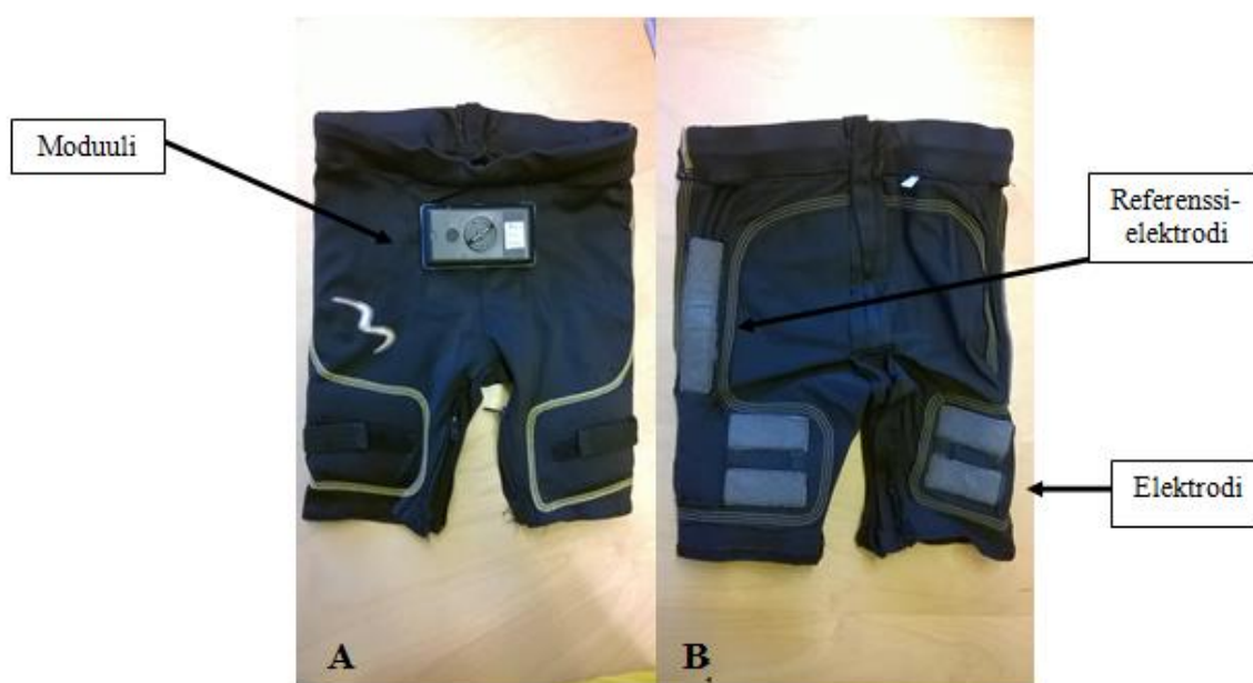
KUVA 10. A. EMG-shortsit (koko 120 cm) sekä moduuli shortsien ulkopuolelta kuvattuna. B. EMG-shortsisiin sisäpuolelle integroidut elektrodit.
