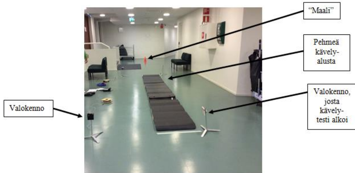
KUVA 9. Paikka, jossa kävely lattialla ja pehmeällä epätasaisella alustalla suoritettiin. Kuvassa näkyy, kuinka pehmeä epätasaisen alusta rakennettiin Liikunta-rakennuksen käytävälle. Lisäksi kuvassa näkyvät valokennot ja ”maali”, jonne tutkittavien lasten tuli kävellä.
