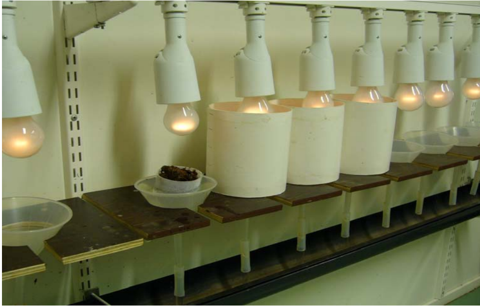
Änkyrimatojen erottelussa käytetty märkäsuppiloerottelulaitteisto. Etualalla erotteluvalmis maanäyte, joka on asetettu muoviverkosta tehtyyn koriin.
