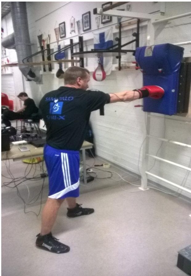
Kuva 5. Takakäden suoran reaktionopeuden ja iskuvoiman mittaustilanne.
