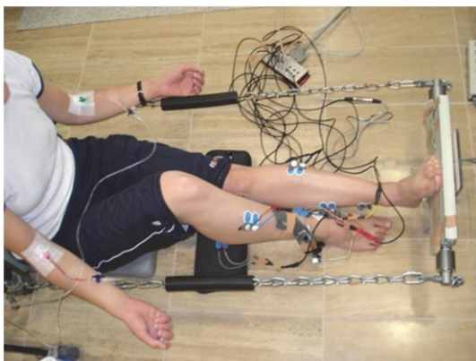
KUVA 13. Laitteisto, jossa lihasvoimamittaukset toteutettiin. Koehenkilö ojensi nilkkaansa voimalevyä vasten mikä oli kiinnitettyä ketjulla selkätukeen. (Masood et al. 2014)
