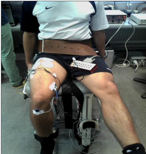
KUVA 3. Koehenkilö voimatuolissa. Tukijalkaa pidettiin korokkeella ja nilkka oli remmillä kiinni (polvikulma 107 astetta). Koehenkilö käytti vyötä vartalon tukemiseen ja käsillä sai ottaa tukea voimatuolista. Stimulaatioelektrodeja oli neljä ja sEMG mitattiin langallisesti VM ja VL -lihaksista.
