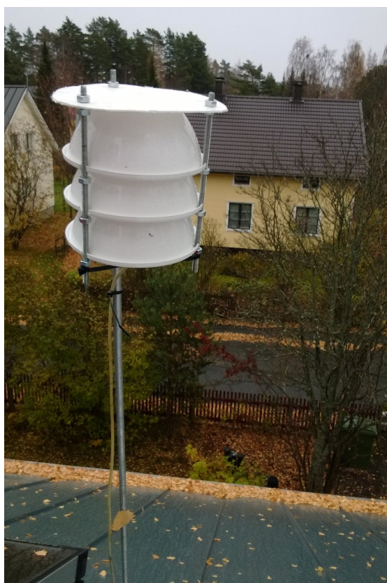
Kuva 5.1: Ulkolämpötilamittauksia varten rakennettu anturikotelo.
