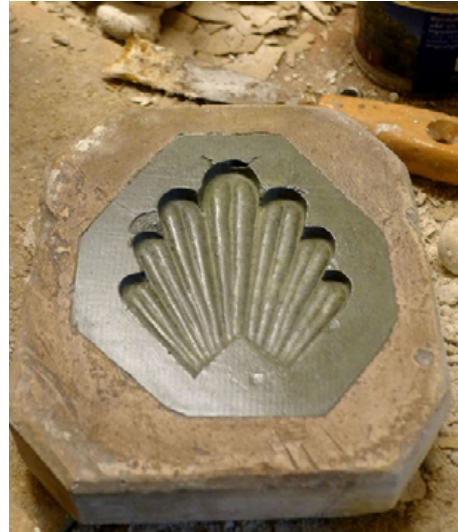
Kuva 11. Kipsillä tuettu, kestävä rikkimuotti simpukkakoristeeseen valamiseen.
