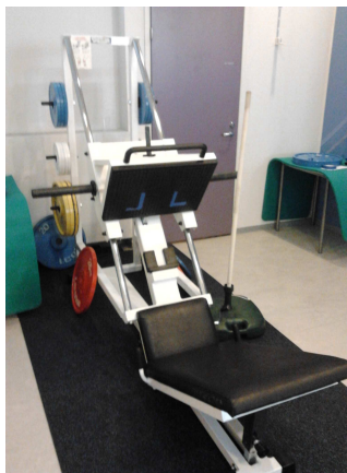
KUVA 23. Jalkojen maksimaalisen dynaamisen ojennusvoiman mittaamiseen käytetty jalka- prässi.
