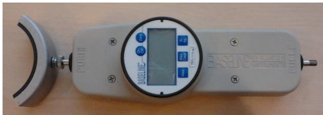
KUVA 22. Lonkan maksimaalisen loitonusvoiman mittaamiseen käytetty dynamometri.
