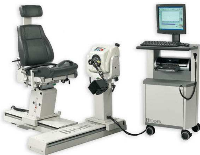
KUVA 21. Polven maksimaalisen isokineettisen koukistus ja -ojennusvoiman mittaukseen käytetty laitteisto.
