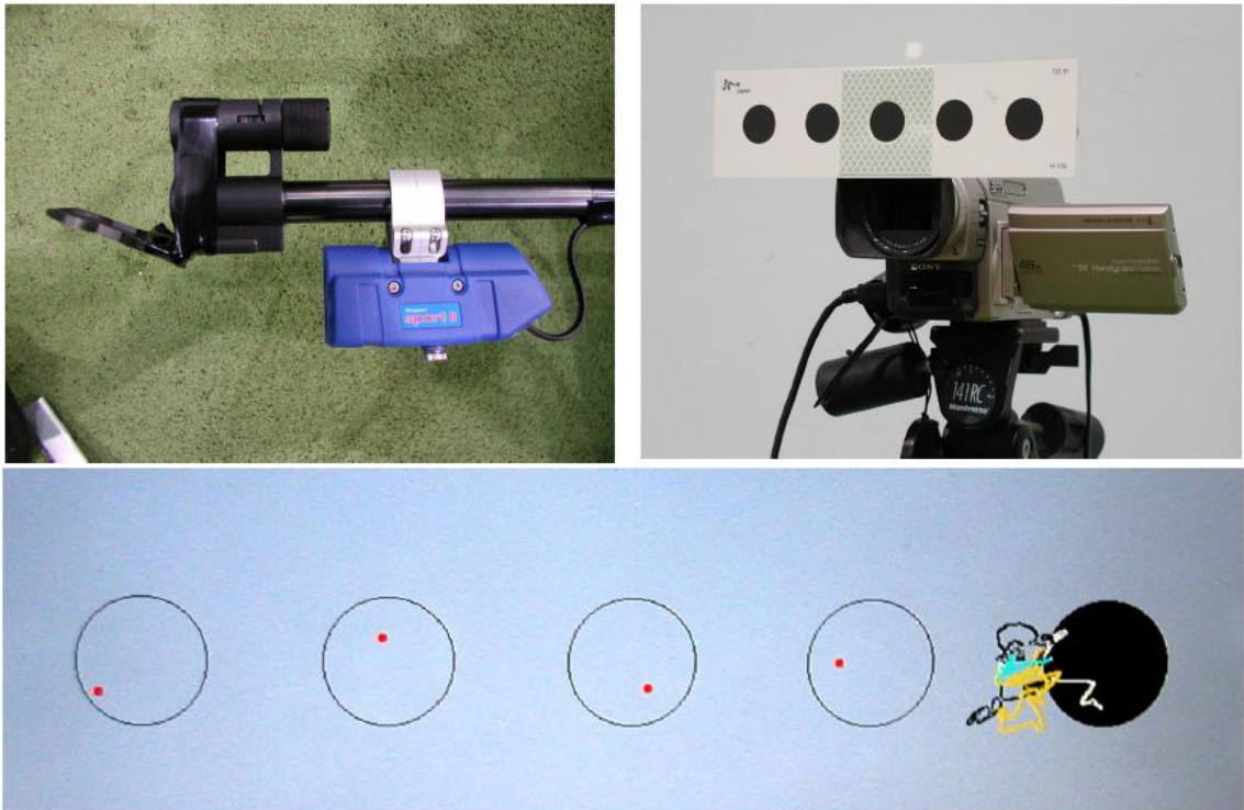
KUVA 7. Optoelektrinen laser-lähetinvastaanotin ja videokuvauksen aseiden liikkeiden mittaamiseksi ampumasuorituksessa (Nummela ym. 2006).
