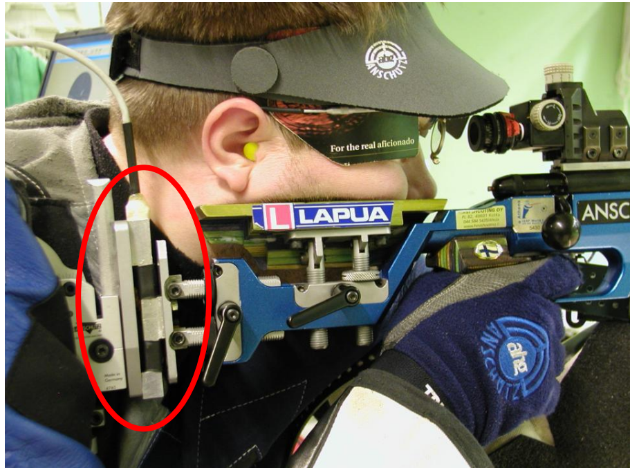
KUVA 12. Mittauksissa käytetty peräanturi.
