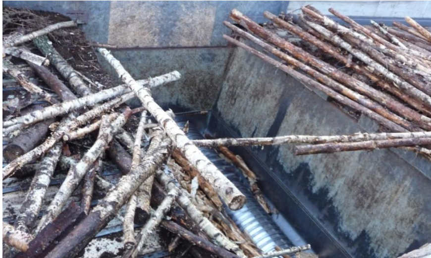
Kuva 7. Murskain ja sitä täyttävät palkkisyöttimet (Valokuva: Orava J.).
