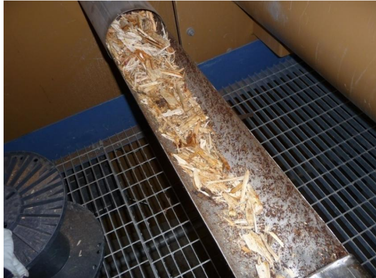
Kuva 8. Murskan alapuolella oleva käsinäyteputki, joka on sisääntyönnettynä suoraan tippuvan polttoainevirran alapuolella (Valokuva: Orava J.).
