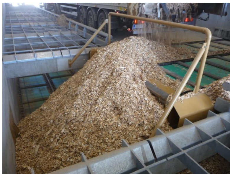
Kuva 17. Nopean purkamisen seurauksena muodostunut hakekasa ruuvien päällä (Valokuva:Orava, J).
