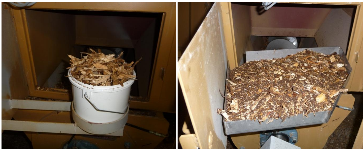
Kuva 14. Kokoomanäyte kerätään joko muoviasiaan tai laatikkoon (oikealla) (Valokuva: Orava J.).
