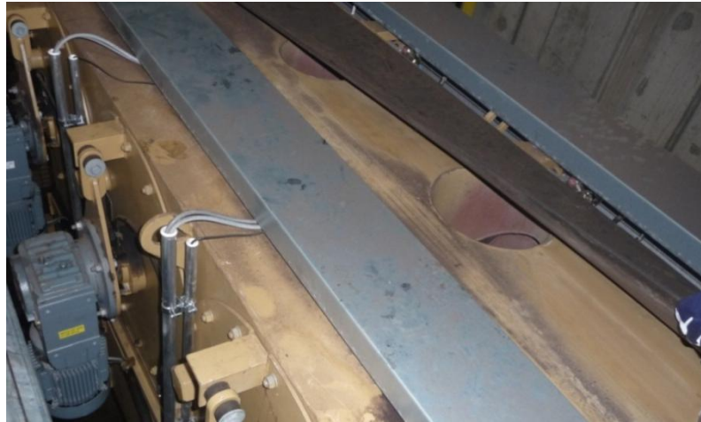
Kuva 13. Sekoitinsäiliöyksikön aukot peittävä hihna raotettuna (Valokuva: Orava J.).
