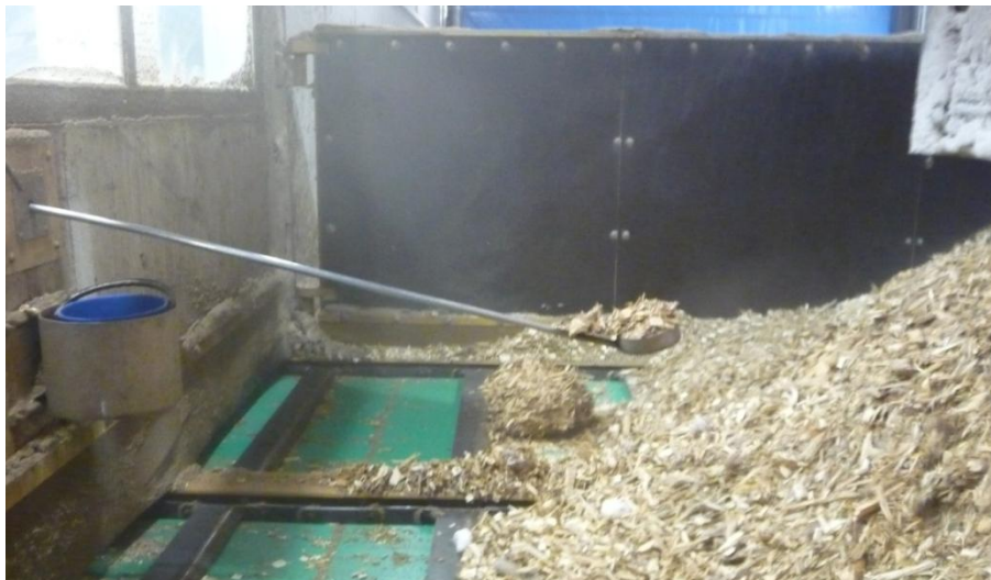
Kuva 5. Standardin mukainen käsinäytteenottokauha (Valokuva: Orava J.).
