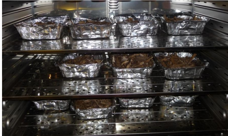
Kuva 15. Lämpökaappi, jossa näytteet kuivattiin (Valokuva: Orava J.).
