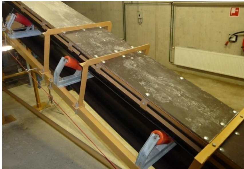
Kuva 10. Päättä suljettu näytehihnakuljetin (Valokuva: Orava J.).
