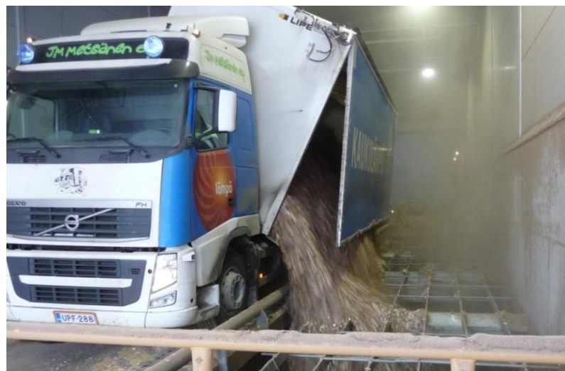
Kuva 2. Auton purku sivukipillä (Valokuva: Orava J.).
