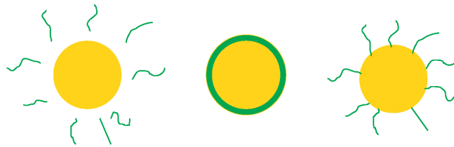
Kuva 2.3: Kultapartikkelien funktionalisointi juosteilla: (vihreät) juosteet kiinnittyvät Van der Waals voimien vaikutuksesta kultapartikkelin pintaan muodostaen kalvon, josta ne sitten irrotetaan osittain adsorboimalla kloori-ioneja kultapartikkelien pintaan, jolloin ionit korvaavat juosteet.
