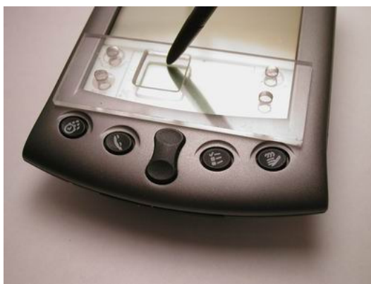
Kuva 3.9: Palmin kämmentietokone EdgeWrite-kehikolla varustettuna. Kirjoituseleet suoritetaan neliönmuotoisella alueella.
