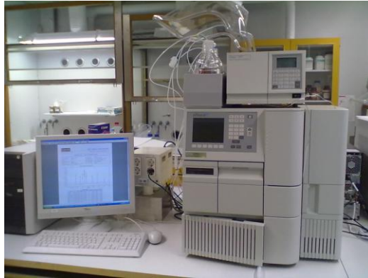
Kuva 8. Työssä käytetty Waters Alliance 2695 nestekromatografi ja 2487 UV -detektori.
