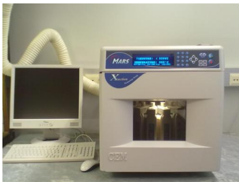
Kuva 12. Työssä käytetty CEM Corporationin MARS 5 mikroaaltouuni.
