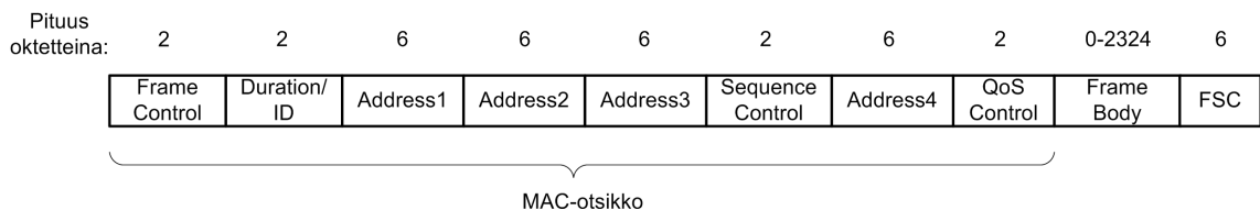
Kuva 2.1: MAC-kehyyksen rakenne [8, sivu 60].
