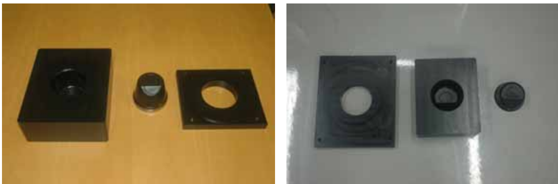
KUVA 5.7 Keittopakkausten valmistusta varten POM-muovista valmistetut muovaustyökalut, vasemmalla työkalut korkeampaa pakkausmuotoa varten (Y) ja oikealla matalampaa pakkausmuotoa varten (X).
