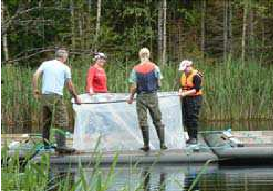
Kuva 1. Mesokosmosten asettaminen lauttakehikoihin ravinnemanipulaatiokoetta varten. Kuva, S. Aalto.
