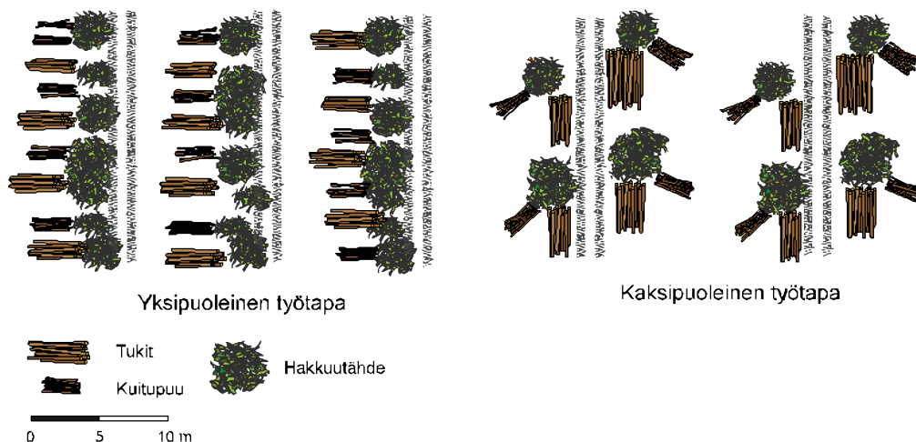
Kuva 5: Hakkuutähteiden kasaamisen tekniikat motolla puita kaadettaessa. (Hakkila ym. 1998)
