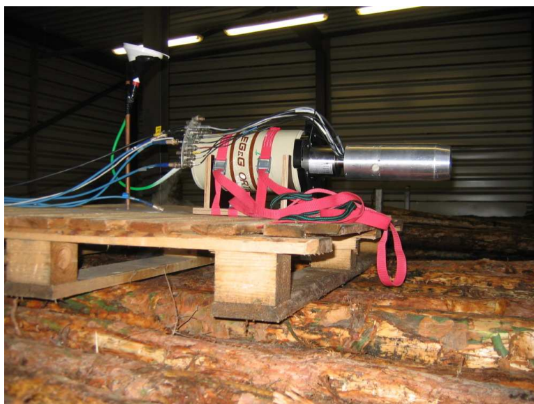
Kuva 28: Ilmaisimien alustallaan tuoreen puukasan päällä. Kuvassa näkyvät myös ilmaisimen tyypitetyössä käytetty letku ja suppilo.
