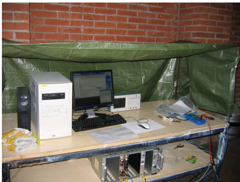
Kuva 27: Käytetty mittauselektronikka. Ylemmällä pöytätasolla tietokone, oskilloskooppi, ylijännitesuoja ja yleismittari. Alemmalla tasolla varsinainen ilmaisinelektronikka.
