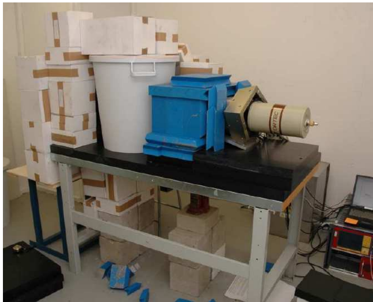
Kuva 16: Toinen mittausgeometria selluhakenäytteille. Laitteisto on kasattu pöydän päälle. Mustat levyt ovat polyeteeniä, siniset tiilet lyijyä ja valkoiset laatikot boorattua parafiinia. Hake on harmaassa muovisaavissa ja ilmaisim oikealla puolella lyijykollimaattorin sisällä. Mittausasetelma painoi niin paljon, että pöytää piti tukea alta päin tunkilla ja sementtitiilillä.
